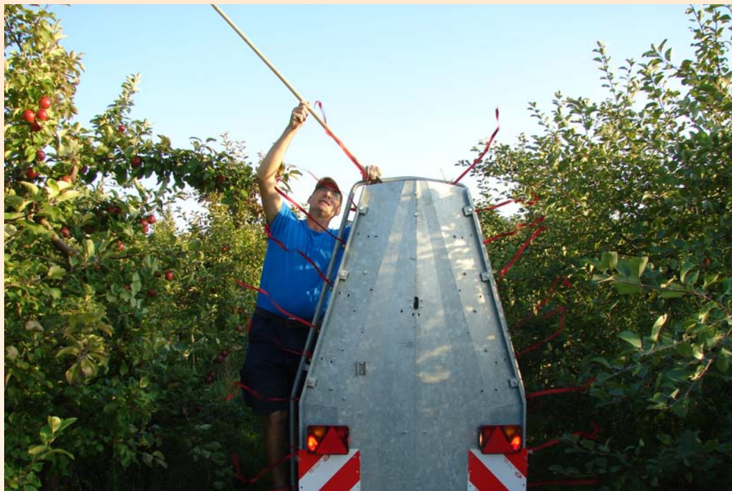
Sprauslas darbības virziens – augšējā sprausla strādā virs koku galotnēm
