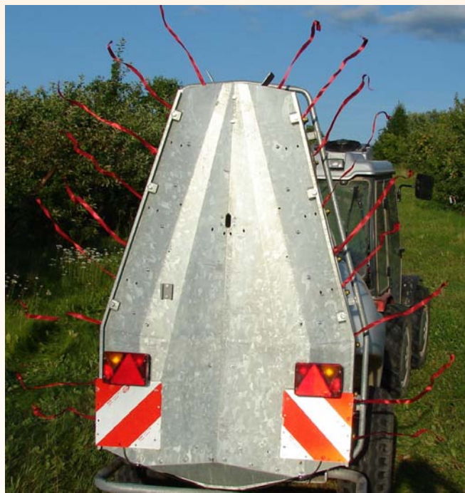
Gaisa plūsma pirms regulēšanas – labā puse ir nedaudz vairāk vērsta augšup
