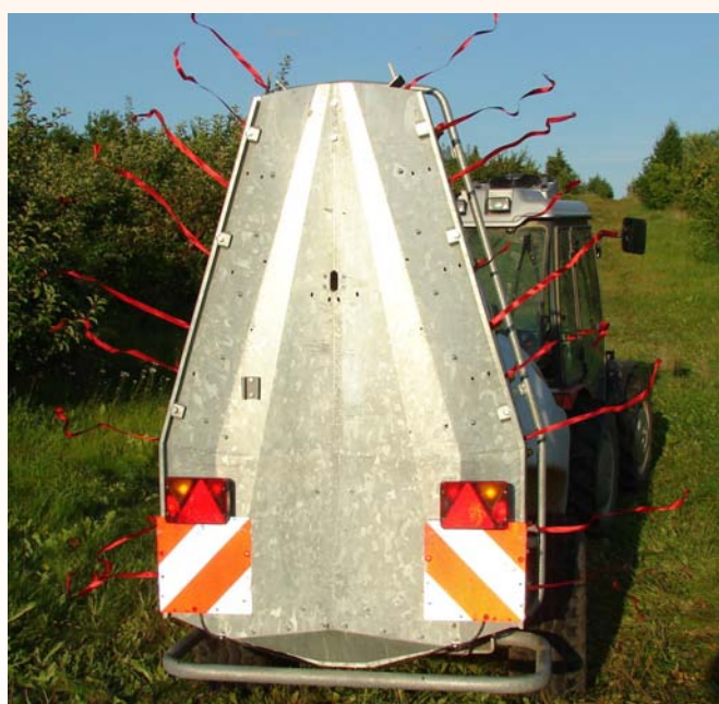
Gaisa plūsma pēc regulēšanas – abas puses apmēram vienādas, gaisa plūsma vairāk virzīta uz sāniem
